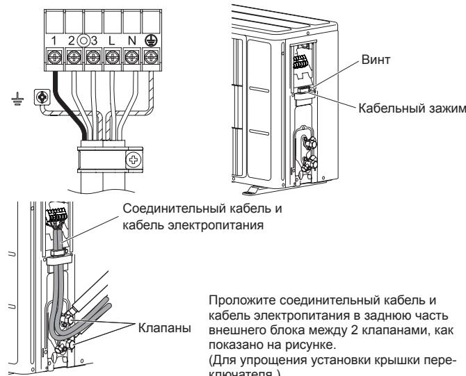
Проложите соединительный кабель и кабель электропитания в заднюю часть внешнего блока между 2 клапанами, как показано на рисунке.
